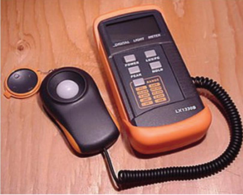
صورة رقم (٢) توضح جهاز اللوكسميتر لقياس وتسجيل شدة الضوء
