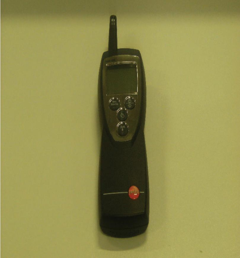
صورة رقم (٧) توضح جهاز قياس درجة الرطوبة والحرارة
